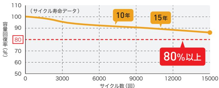
[試験条件] 電池に過酷な3C(定格容量の3倍の電流)での充放電サイクル@25°C
