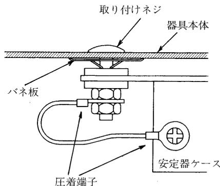
3. 安定器ケースと取り付けネジとの接続にアース座金を用いているものがあります。バネ板などで固定された取り付けネジ側に、アース座金を用いれば接地がなされます。アース座金については、お問い合わせください。
