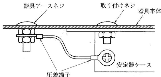
2. バネ板などで固定された取り付けネジは、器具にアースされていますので安定器ケースをその取り付けネジにアースすれば接地がなされます。**固定ネジ側でアースを取ってください。**
