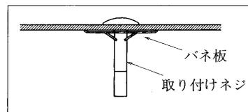
2. **バネ板**：安定器の取り付けネジがバネ板で器具に固定されているものがある場合、そのネジと穴をそのまま使用してください。
